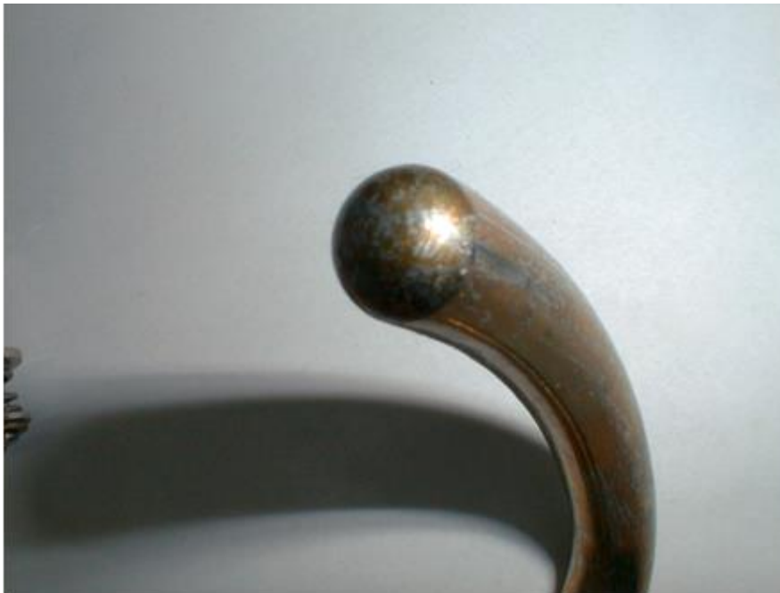
Styk ruchomy komory małaolejowej rozłącznika/rozłączniko-uziemnika Fla 15/60 zdemontowanej po 15 latach pracy, podlega wymianie
