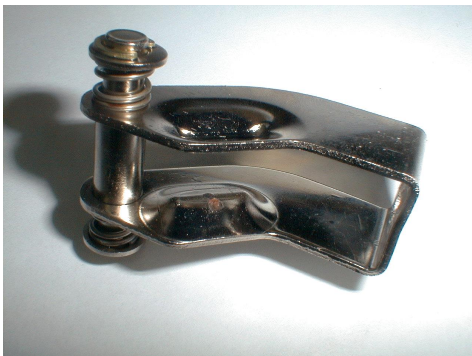
Styk stały komory małoolejowej rozłącznika/rozłączniko-uziemnika Fla 15/60 zdemontowanej po 15 latach pracy, podlega wymianie.
